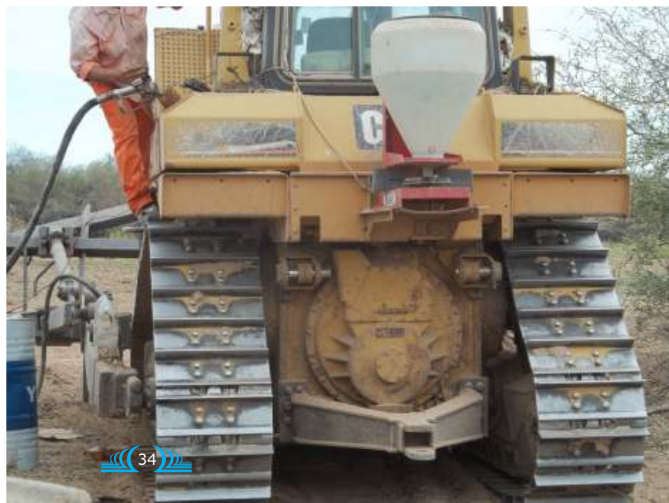
Figura 1. Sembradora para uso en rolados. B "plato"
